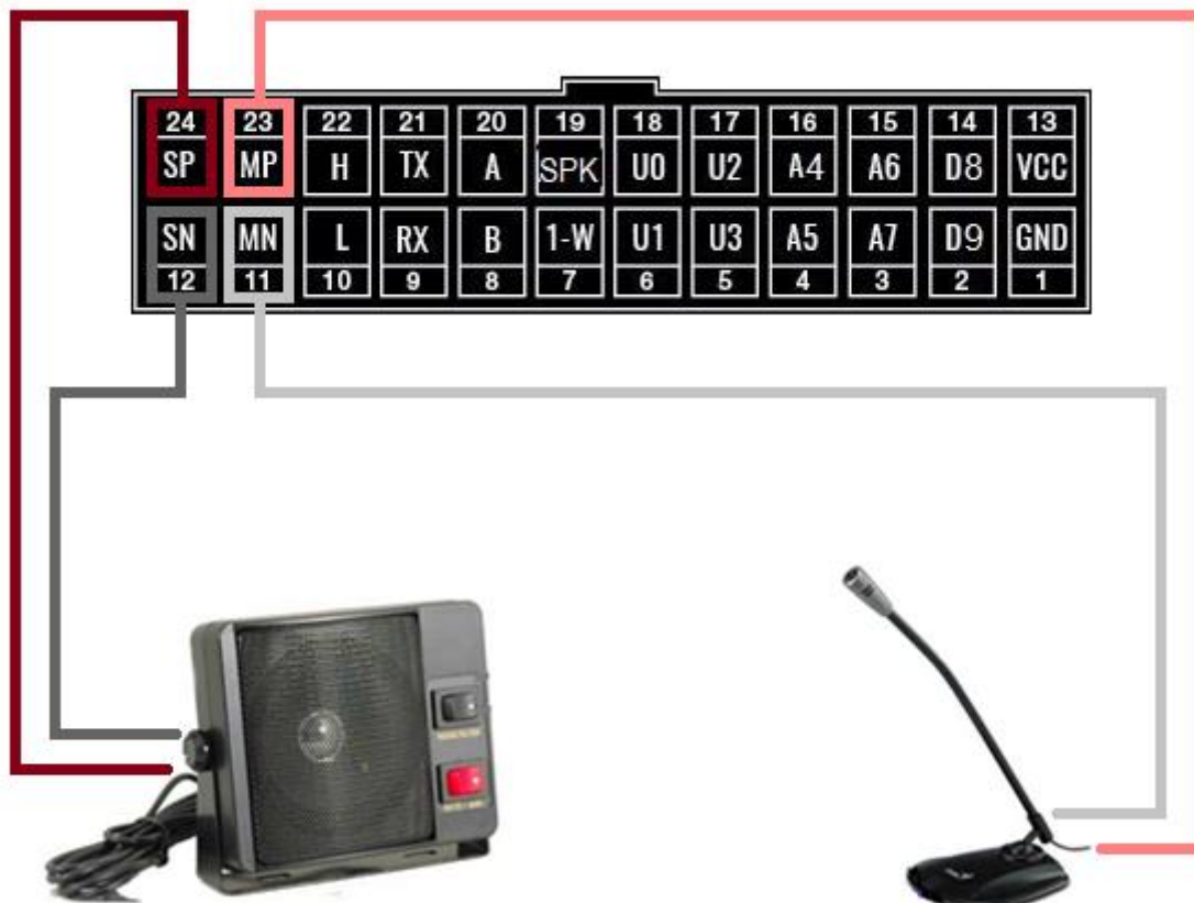
Рисунок 9 – Схема подключения микрофона и динамика
